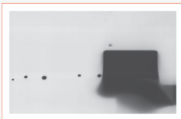
شکل ۴- فیلم تابش دیده با تکنیک الکترونی با دو میدان ۹۰ درجه نسبت به هم
