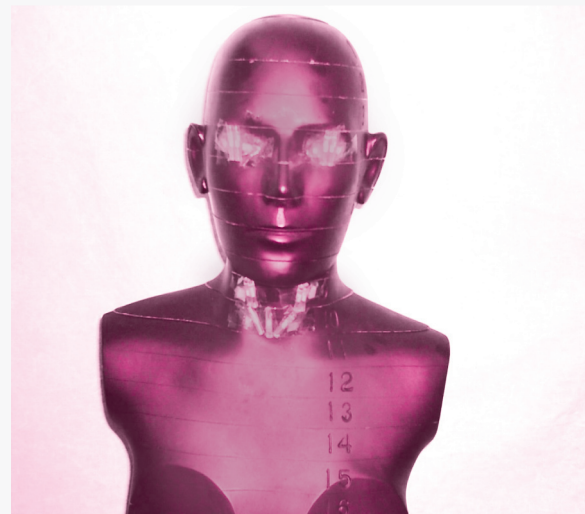
شکل ۲: فانتوم راندو دزیمترها روی ناحیه تیروئید و چشم‌ها قرار گرفته‌اند.
